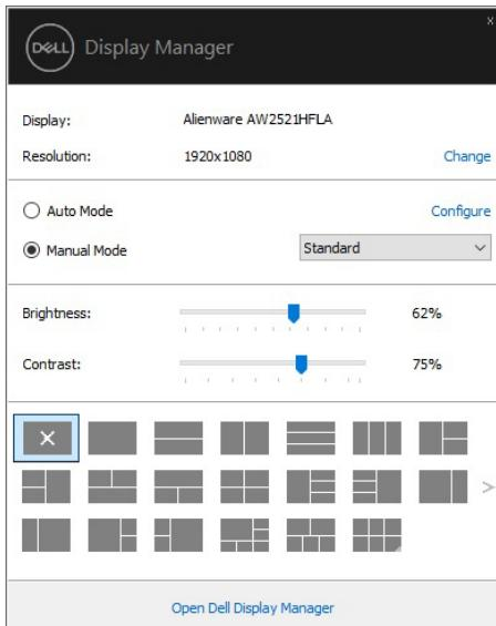
Från dialogrutan **Snabbinställningar** kommer du även åt Dell Display Managers avancerade användargränssnitt som används för att justera grundläggande funktioner, konfigurera automatiskt läge och komma åt andra funktioner.
