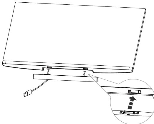
2. Spojite USB kabel soundbara na USB priključak Dell monitora. U slučajevima kada monitor povežete HDMI ili DP kabelom, osigurajte da USB kabel koji ste dobili uz monitor spojite na računalo kako bi soundbar radio.
