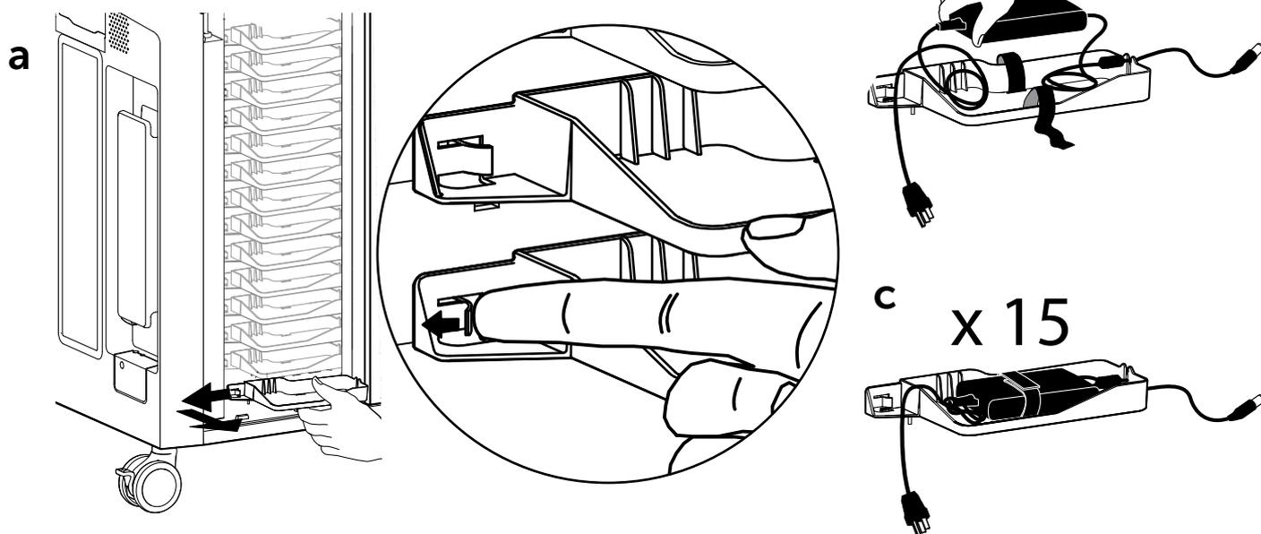
**3** Instradare il connettore dell'adattatore nel vano per i dispositivi.
