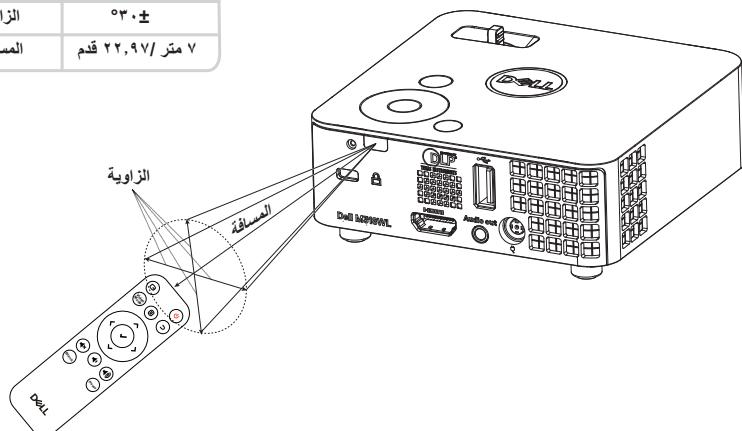
ملاحظة: قد يختلف نطاق التشغيل الفعلي إلى حد ما عما ورد بالرسم التوضيحي، كما تحول البطاريات الضعيفة دون تشغيل وحدة التحكم عن بعد للجهاز بصورة صحيحة.
