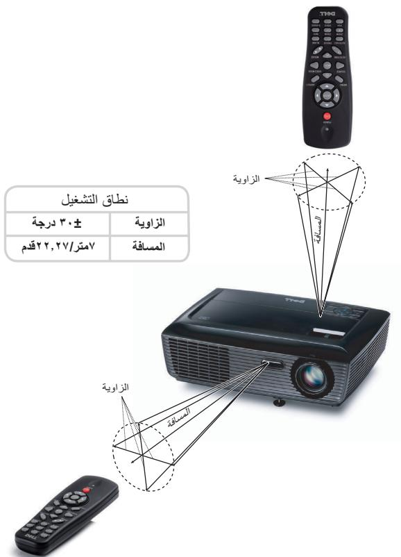
**ملاحظة:** قد يختلف نطاق التشغيل الفعلي إلى حد ما عما ورد بالرسم التوضيحي. كما تحول البطاريات الضعيفة دون تشغيل وحدة التحكم عن بعد للجهاز بصورة صحيحة.
