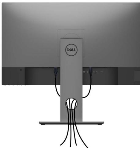
将所有必要的线缆连接到显示器和计算机后，（请参见“[连接显示器](#)”连接线缆）整理好所有线缆，如上所示。
