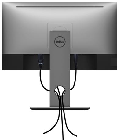
モニターとコンピューターに必要なケーブルをすべて接続したら（ケーブル接続については、[モニターの接続](#)を参照）、上記に示すようにすべてのケーブルを整理します。
