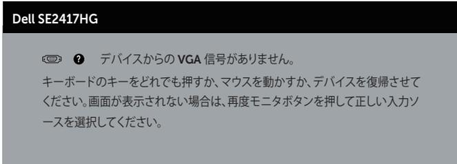
VGA または HDMI ケーブルが接続されていない場合、下の画像のようなフローティングダイアログボックスが表示されます。この状態が続くと、モニターは 5 分後に省電力モードに入ります。
