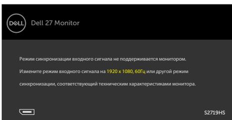
Это означает, что монитор не может произвести синхронизацию с получаемым от компьютера сигналом. Информацию о диапазонах частоты строк и кадров, применимых к данному монитору, см. в разделе [Технические характеристики монитора](#). Рекомендуется разрешение 1920 x 1080.
