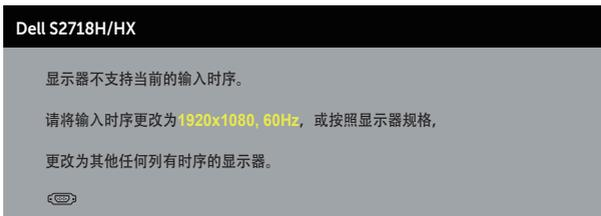
这表示显示器不能与它从计算机接收的信号同步。请参见[显示器规格](#)了解此显示器支持的水平和垂直频率范围。推荐模式是 1920 × 1080。
