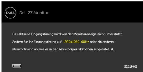
Das bedeutet, dass sich der Monitor mit dem vom Computer empfangenen Signal nicht synchronisieren kann. Siehe [Technische Daten des Monitors](#) für die horizontalen und vertikalen Frequenzbereiche, die für diesen Monitor adressierbar sind. Empfohlener Modus ist 1920 x 1080.
