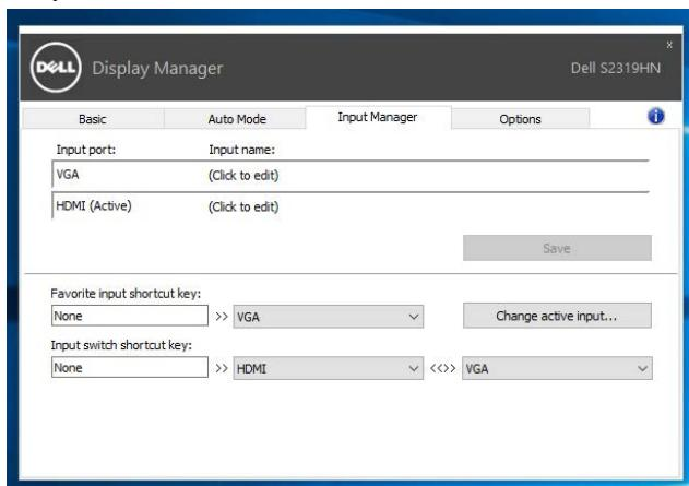
**NAPOMENA:** DDM komunicira s vašim monitorom čak i kada monitor prikazuje video sa drugog računara. DDM možete instalirati na računaru koji često koristite i kontrolisati prebacivanje ulaza sa njega. Takođe možete instalirati DDM na druge računare povezane s monitorom.
