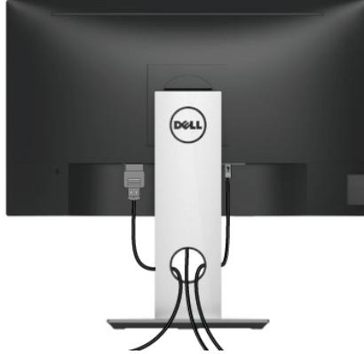
Setelah memasang semua kabel yang diperlukan ke monitor dan komputer, (Lihat [Menyambungkan Monitor](#) untuk pemasangan kabel,) atur semua kabel seperti ditunjukkan di atas ini.
