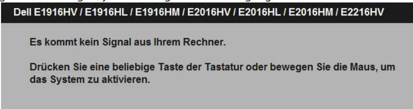
Ist das VGA-Kabel nicht angeschlossen, erscheint ein schwebendes Dialogfenster, siehe unten. Der Monitor ruft **nach 5 Minuten den Energiesparmodus** auf, wenn er in diesem Zustand belassen wird.
