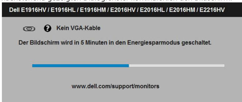
4. Dieses Fenster erscheint auch während des normalen Systembetriebs, falls das Videokabel abgezogen wird oder beschädigt ist. Der Monitor ruft **nach 5 Minuten den Energiesparmodus** auf, wenn er in diesem Zustand belassen wird.
