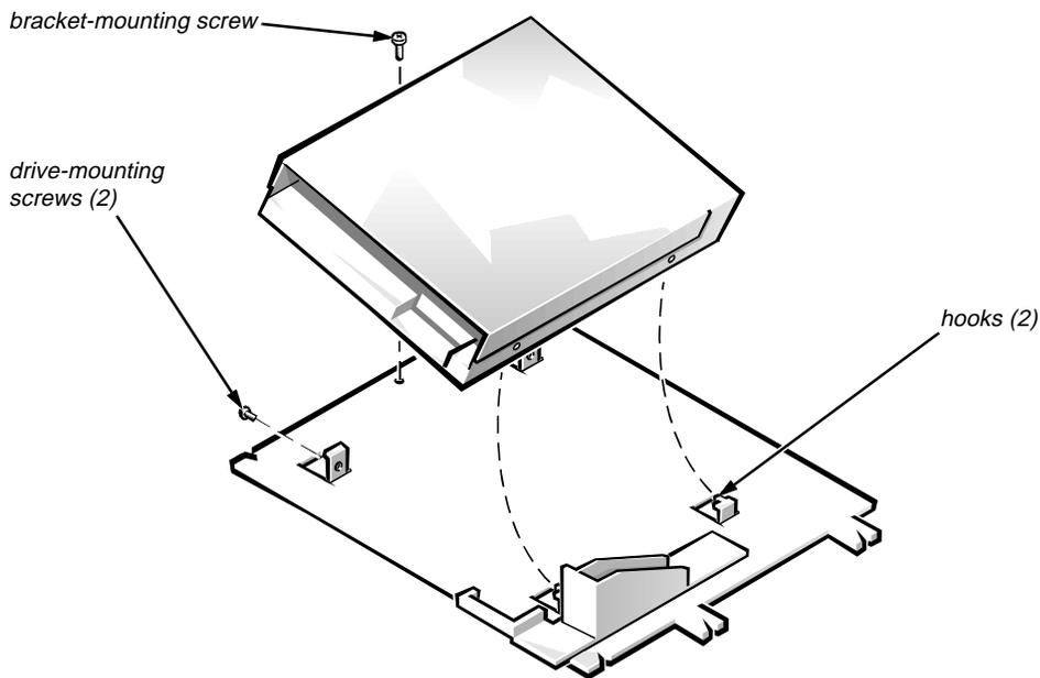
**Figure 5-7. 3.5-Inch Diskette Drive Removal**
