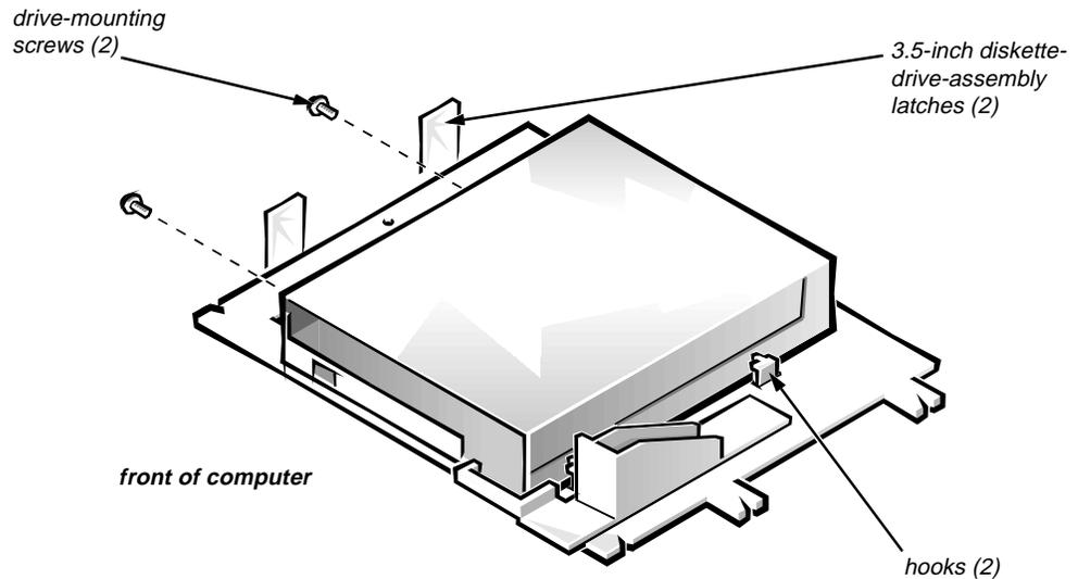
**Figure 4-6. 3.5-Inch Diskette Drive Removal**
