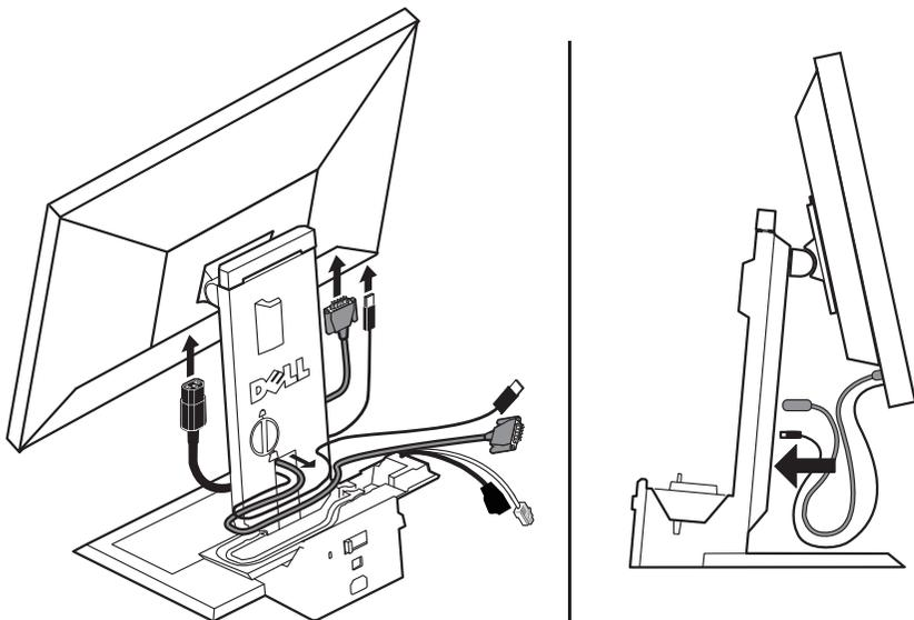
**5** Encaixe o cabo do monitor na canaleta de cabo, deixando uma folga suficiente.
