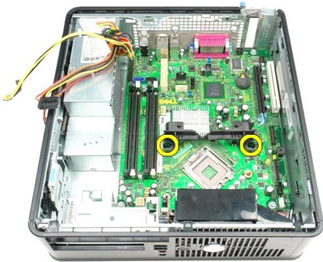
13. ヒートシンク固定モジュールを取り外します。
