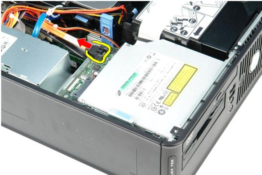
4. ドライブリリースラッチを引き上げ、光学ドライブをコンピュータの背面方向にスライドさせます。
