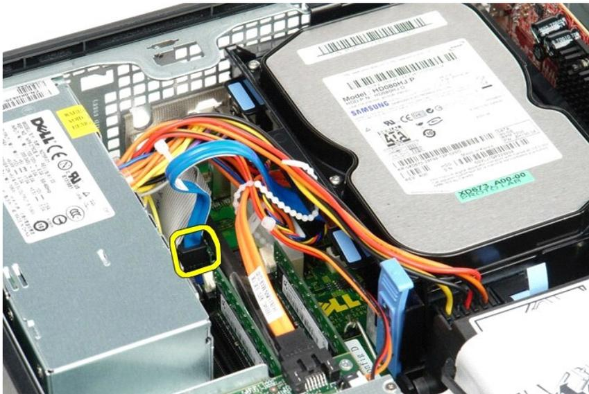
4. ドライブシャーシ両端の 2 つの青色の固定タブを押し入れ、ドライブシャーシを上にもスライドさせてコンピューターから取り出します。
