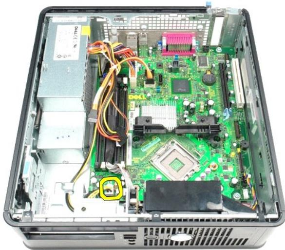
8. ハードドライブとオプティカルドライブのデータケーブルをシステム基板から外します。
