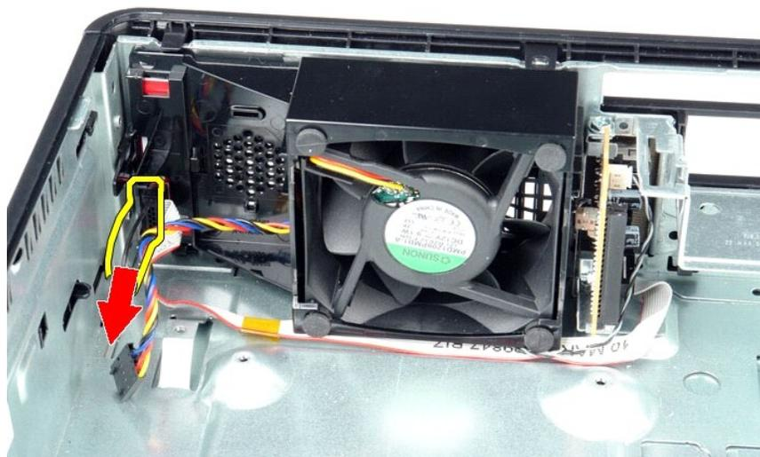
4. 固定クリップを押して、コンピューターシャーシからファンを取り外します。
