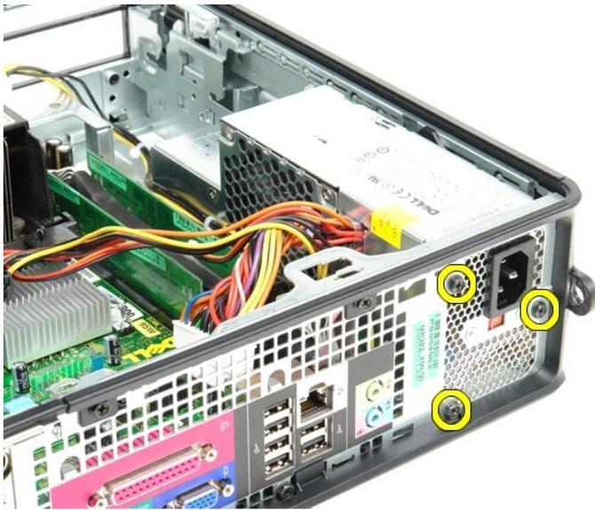
7. 電源ユニットをコンピュータの前面へスライドさせます。
