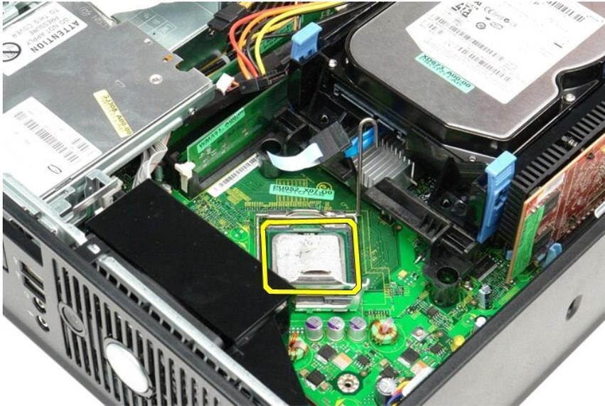
△ **注意:** プロセッサを取り付ける際は、ソケット内側のピンに触れたり、ピンの上に物を落とさないようにしてください。
