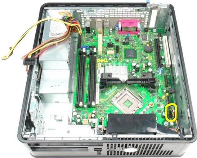
12. ヒートシンク固定モジュールをシステム基板に固定しているネジを外します。
