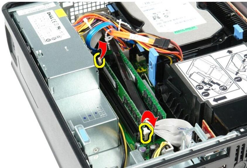
3. メモリモジュールを持ち上げながら、システム基板のコネクターから取り外します。
