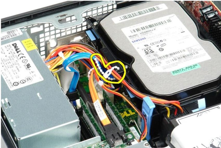
3. データケーブルをシステム基板から外します。
