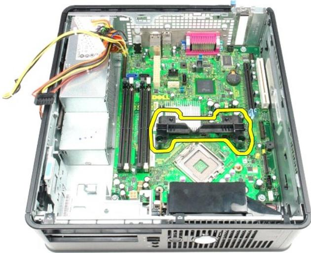
14. システム基板をコンピューターシャーシに固定しているネジを取り外します。
