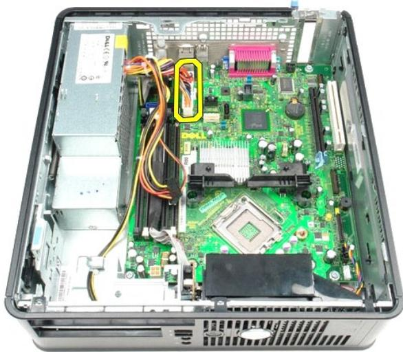
10. IO パネルケーブルをシステム基板から外します。
