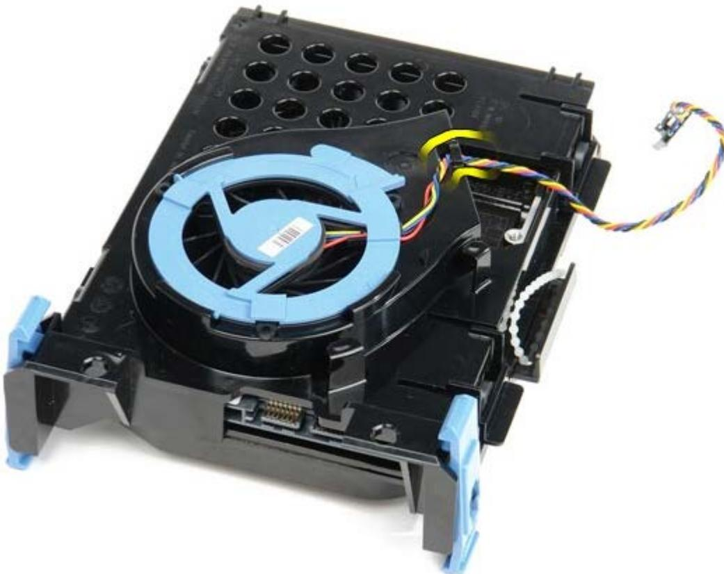
11. Pour dégager le ventilateur du disque dur, soulevez la languette bleue et tournez dans le sens inverse des aiguilles d'une montre.
