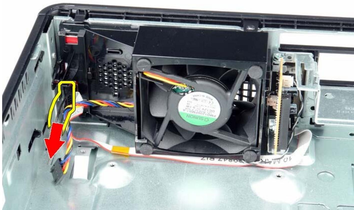
4. Pressez le clip de fixation pour dégager le ventilateur du châssis de l'ordinateur.
