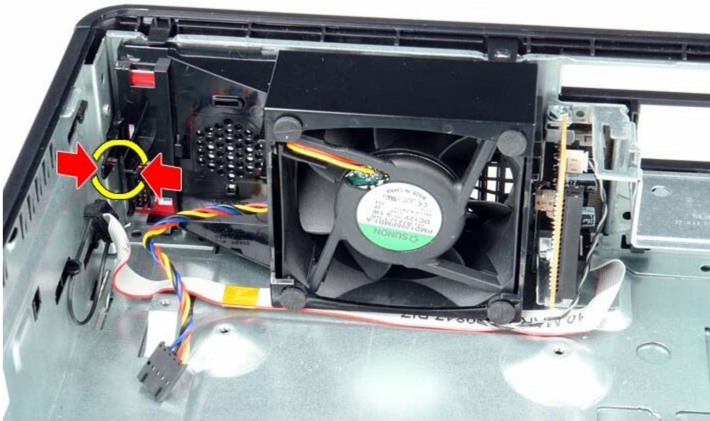
5. Penchez le ventilateur vers l'avant et retirez-le du châssis de l'ordinateur.
