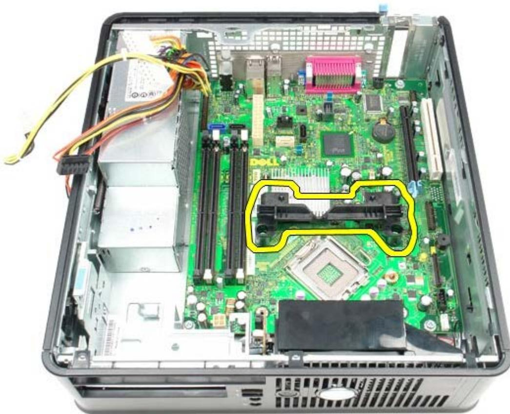
15. Déposez les vis qui fixent la carte système au châssis de l'ordinateur.
