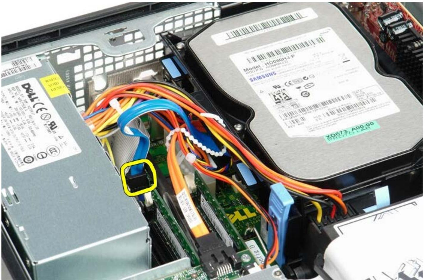
4. Appuyez sur les deux languettes de fixation bleues situées de chaque côté du disque dur et faites glisser le châssis du disque dur vers le haut pour le retirer de l'ordinateur.
