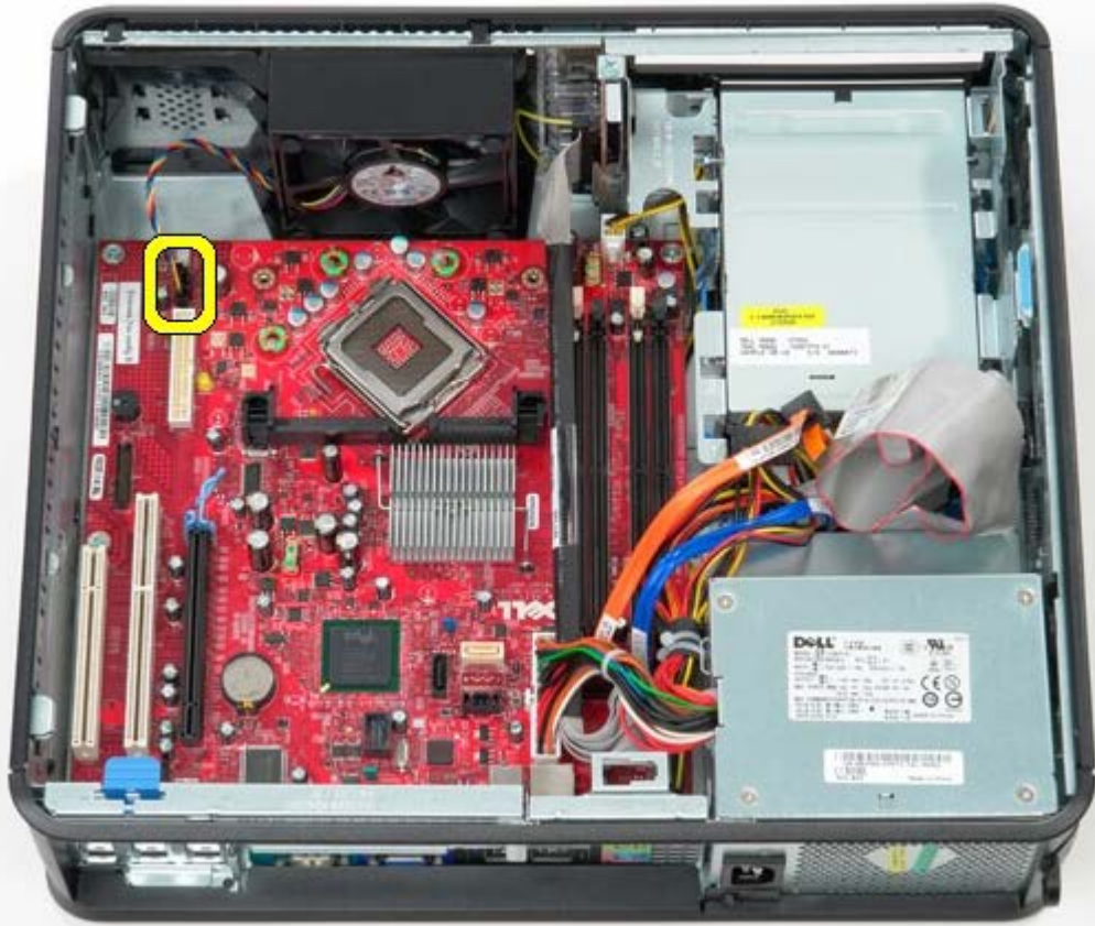
1 11 断开主电源电缆与系统板的连接。
