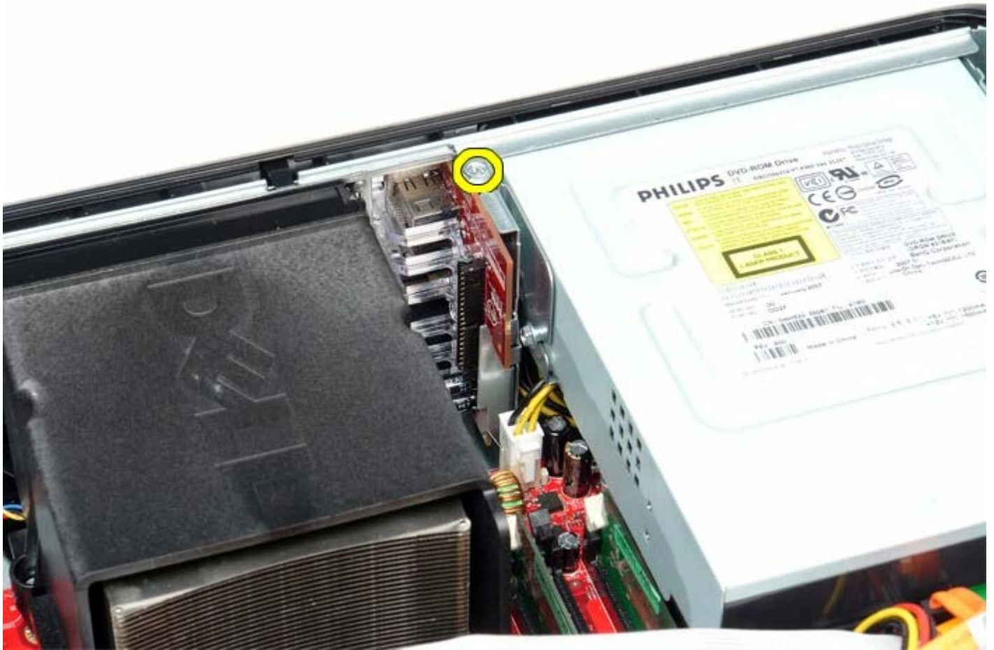
1 11 轻轻旋转 IO 面板，使其脱离计算机，然后从计算机卸下。
