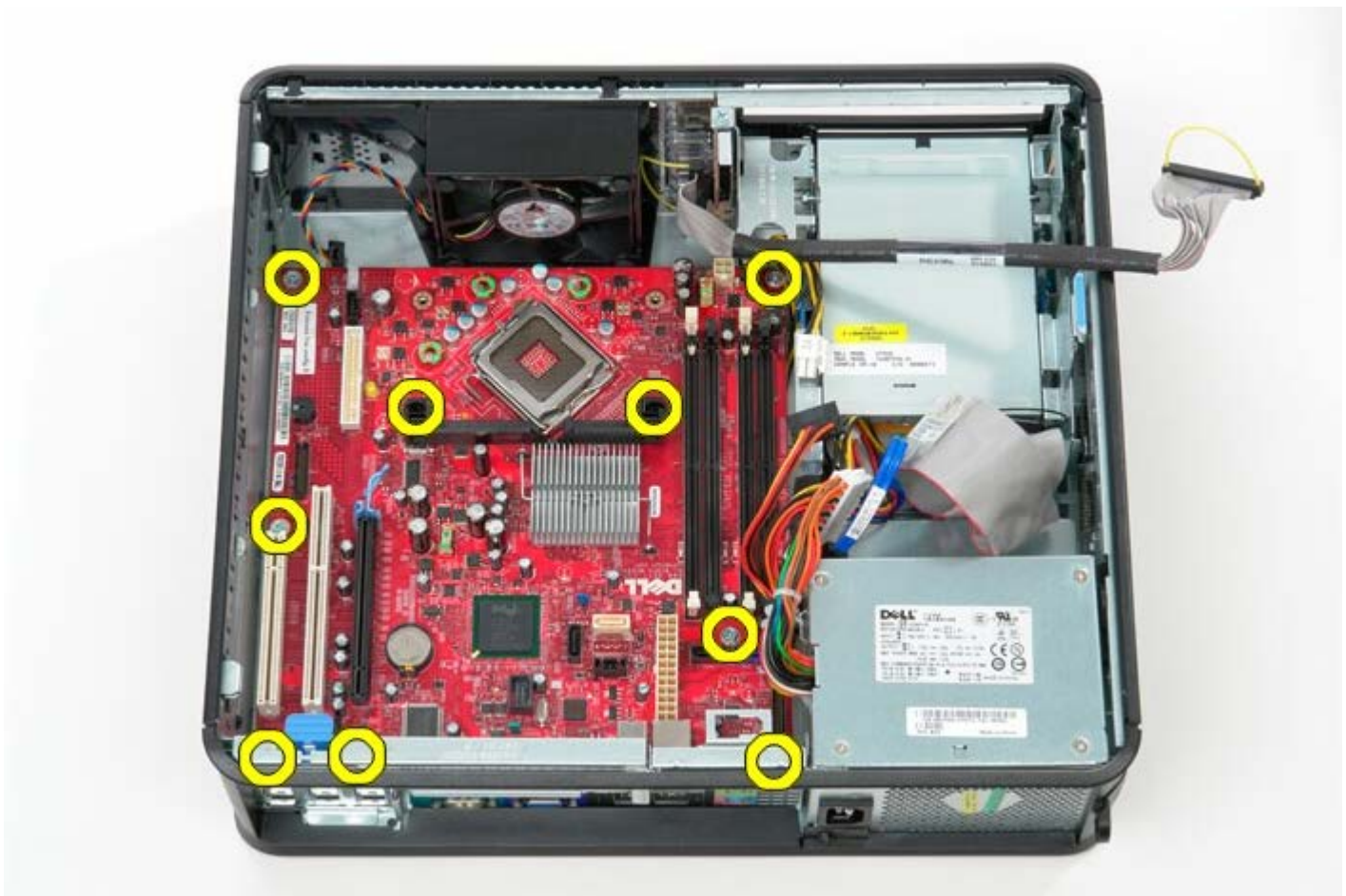
1 1 11 卸下散热器部件支架。
