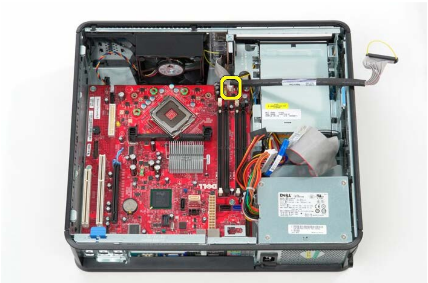
11 11 拧下将系统板固定到计算机机箱的螺钉。
