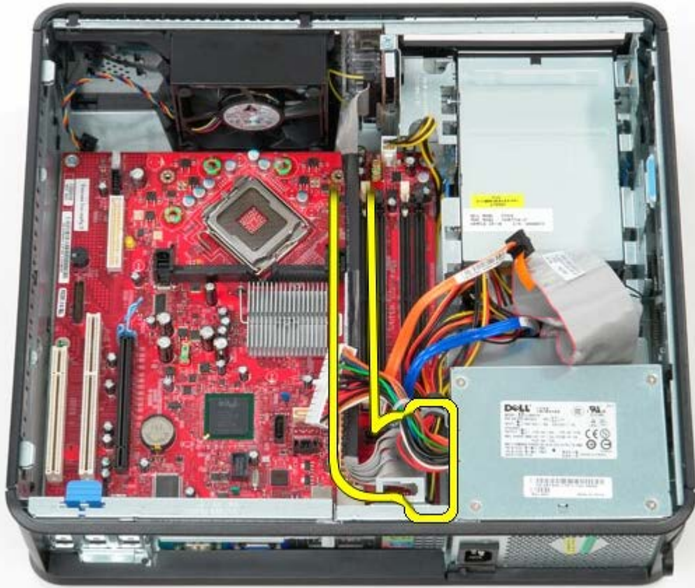
1 1 11 断开软盘驱动器数据电缆与系统板的连接。
