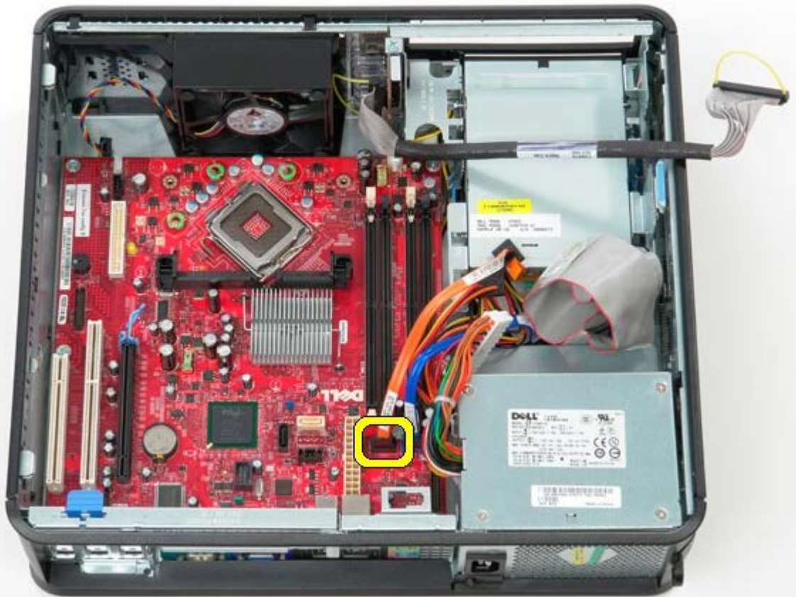
1 1 11 断开硬盘数据电缆与系统板的连接。
