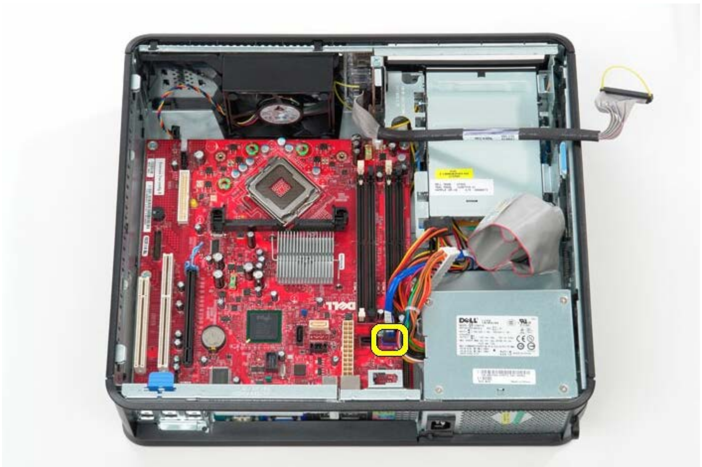
11 11 断开处理器电源电缆的连接。
