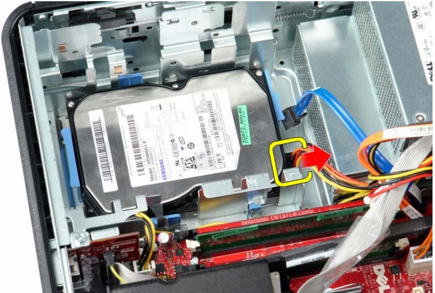
1 11 向内按压驱动器每侧的固定夹，并朝计算机背面滑动驱动器。
