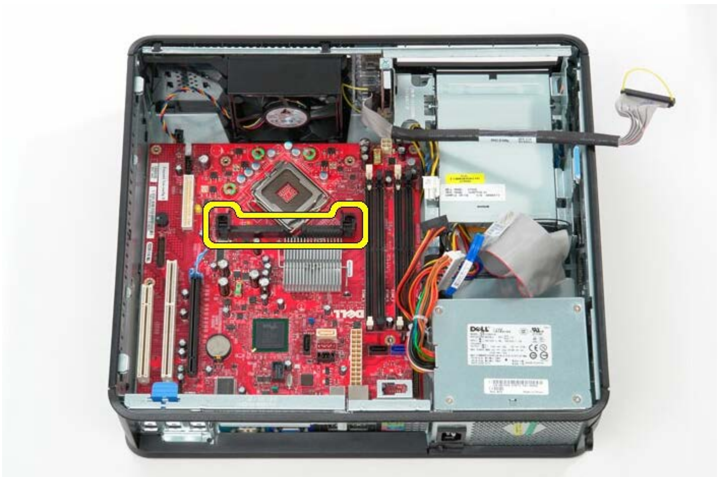
1 1 11 要卸下系统版，朝计算机背面滑动系统板并提起系统版，将其从计算机中取出。
