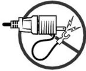
3. 如果您的交流電源線有用於連接電源插座的綠色接地線，請將金屬接地連接器連接至插座上的接地端 (通常為一個螺絲) (參見下圖)：
