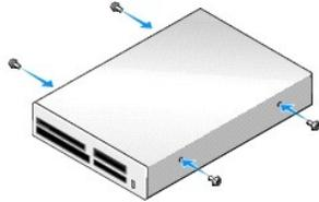
3. 將媒體讀卡器上的側面螺絲對準側面螺絲插槽，並輕輕地將其滑入支架中，直至其卡入到位。
