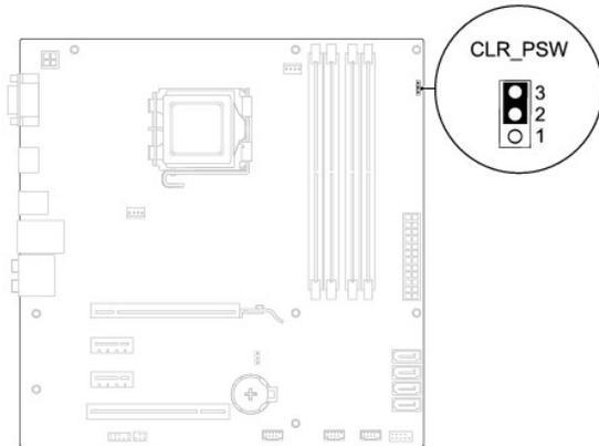
4. Lepaskan plug jumper 2-pin dari pin 2 dan 3 lalu pasang pada pin 1 dan 2.
