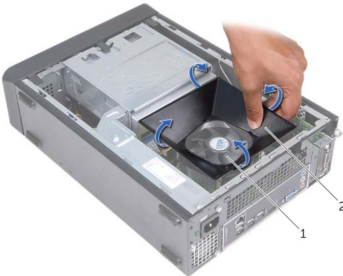
1 conjunto de ventilador e dissipador de calor do processador
