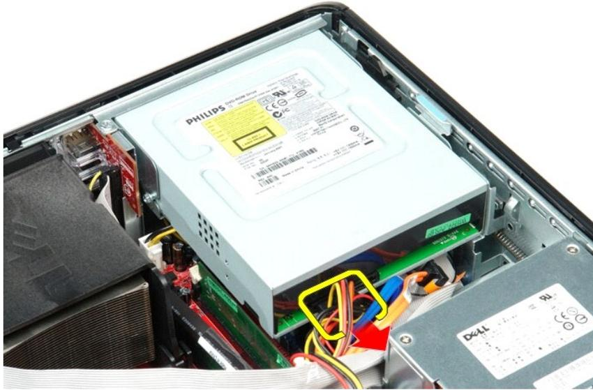
4. ドライブリリースラッチを持ち上げ、ドライブをコンピュータの背面方向にスライドさせます。
