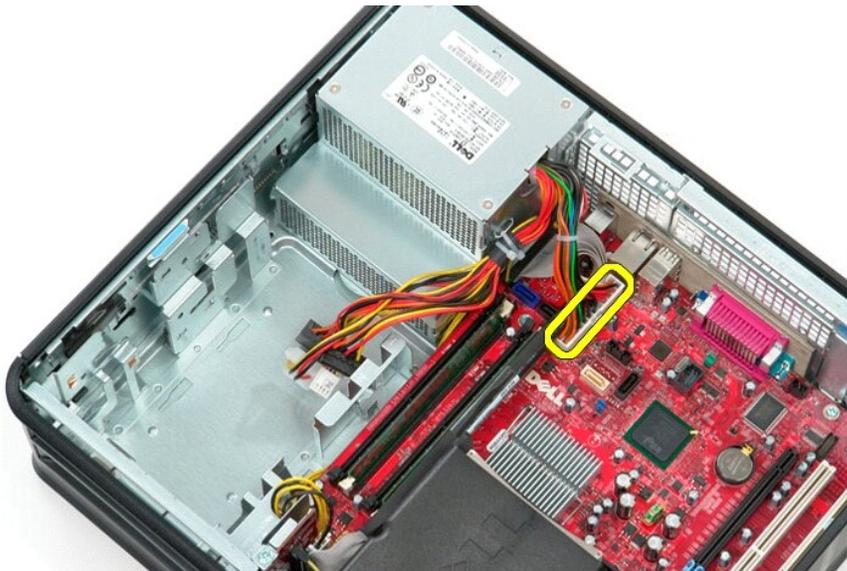
6. プロセッサ電源コネクタをシステム基板から外します。
