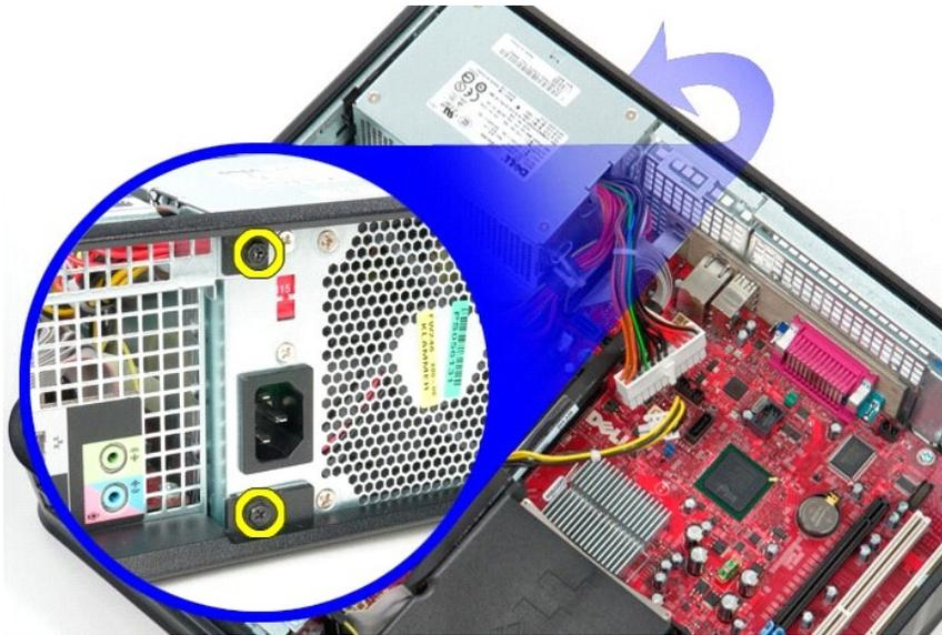
9. シャーシの底にある電源ユニットのリリースラッチを押して、コンピュータの前面に向かって電源ユニットをスライドさせます。
