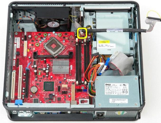
12. システム基板をコンピュータシャーシに固定しているネジを取り外します。
