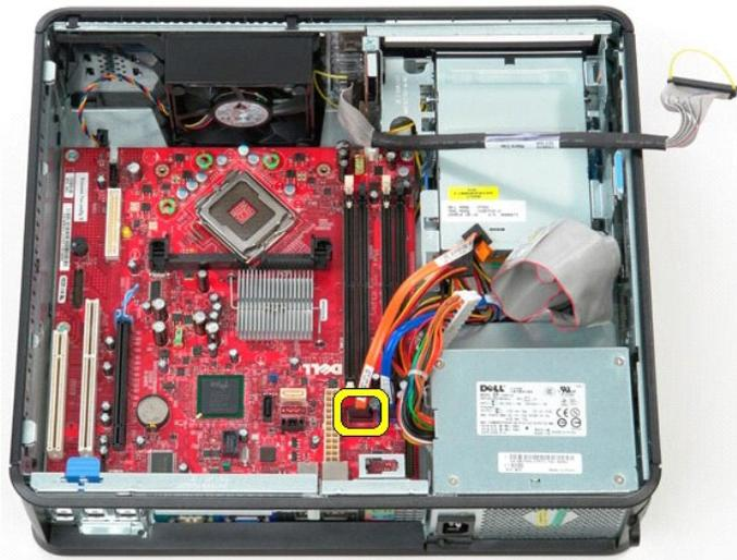
10. ハードドライブのデータケーブルをシステム基板から外します。
