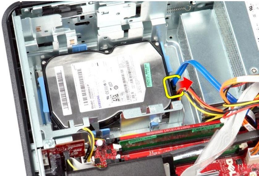
4. ハードドライブの電源ケーブルをハードドライブから外します。
