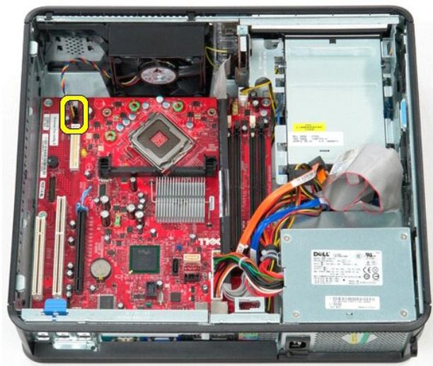
7. メイン電源ケーブルをシステム基板から外します。
