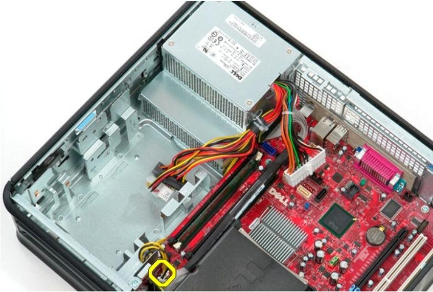
7. プロセッサ電源コネクタケーブルをシステム基板の下の配線ガイドから外します。
