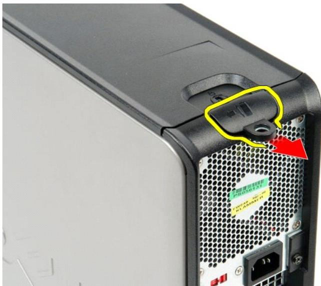
3. コンピュータのカバーをトップから外側に傾け、コンピュータから取り外します。
