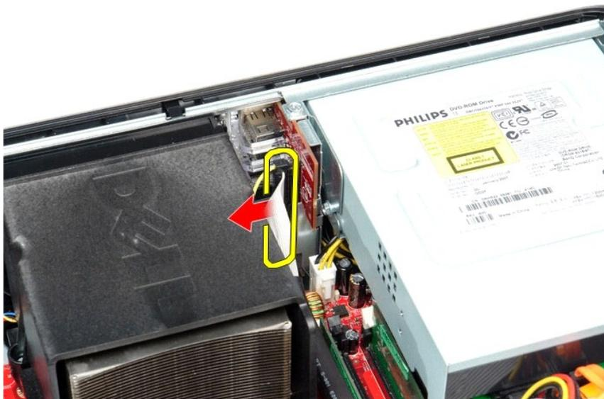
3. I/O パネルを固定しているネジを外します。
