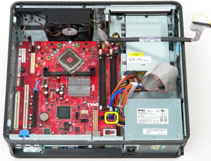
11. プロセッサ電源ケーブルをシステム基板から外します。
