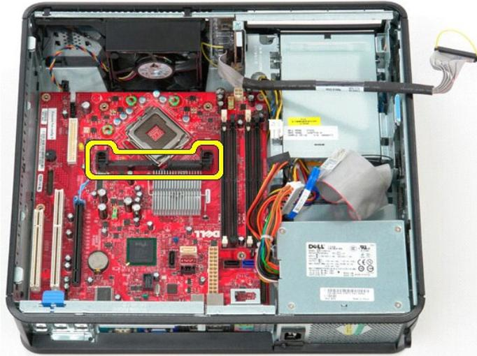
14. システム基板を取り外すには、システム基板をコンピュータの背面に向かってスライドさせ、コンピュータからシステム基板を持ち上げながら取り外します。
