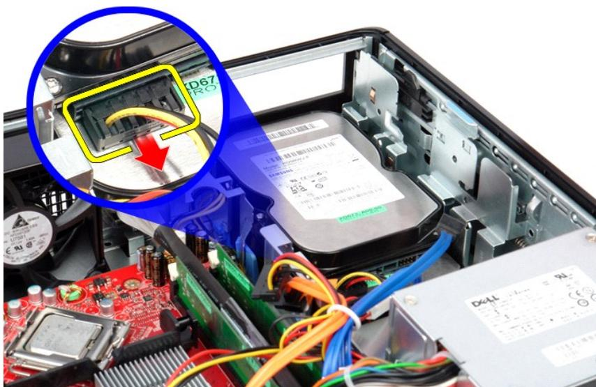
5. リリースラッチを引き上げ、ハードドライブをコンピュータの背面方向にスライドさせます。
