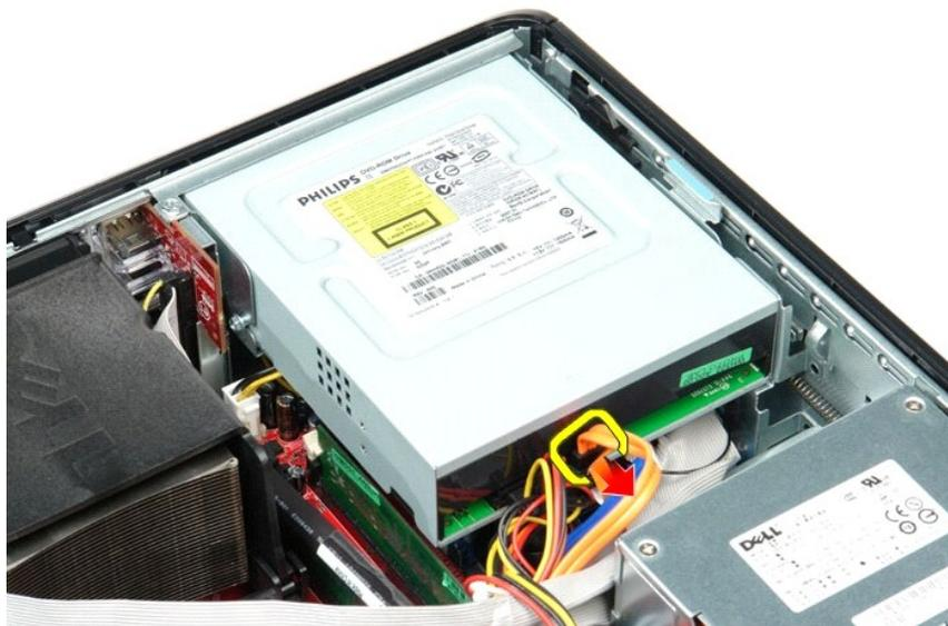
3. 光学ドライブ電源ケーブルを外します。
