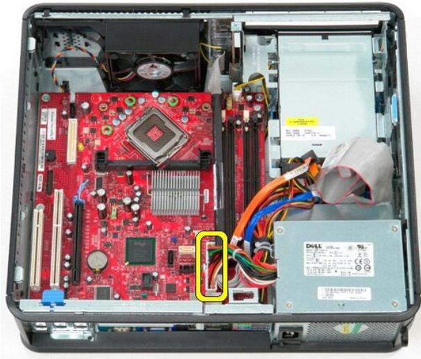
8. IO パネルケーブルをシステム基板から外します。
