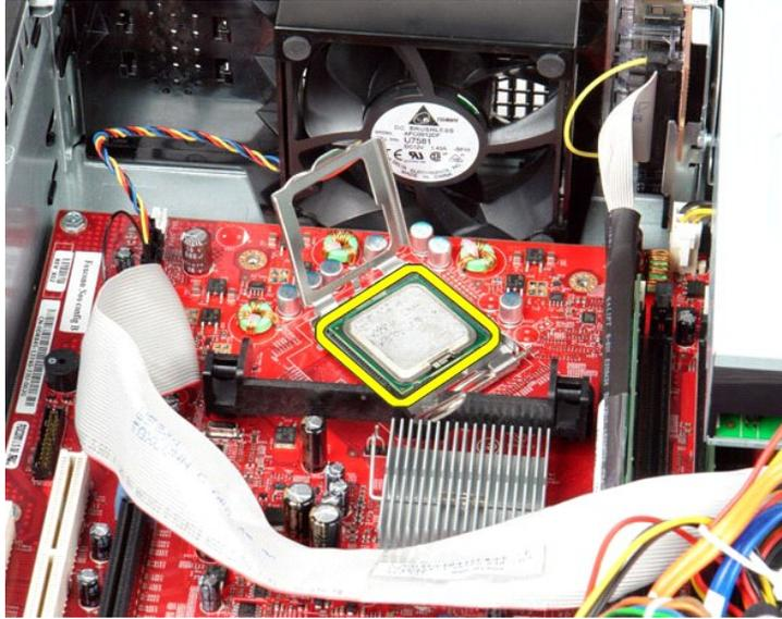
△ **注意:** プロセッサを取り付ける際は、ソケット内側のピンに触れたり、ピンの上に物を落とさないようにしてください。
