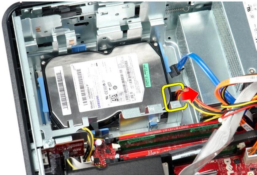
5. ハードドライブ両端にある青い固定タブを押し込み、ハードドライブをコンピュータの背面方向にスライドさせます。
