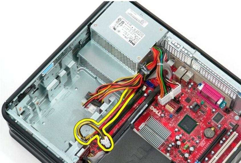
8. Retirez les vis qui fixent le bloc d'alimentation à l'arrière du châssis.
