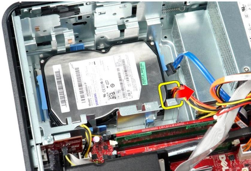
5. Appuyez sur les deux pinces de fixation de chaque côté du disque dur, et faites-le glisser vers l'arrière de l'ordinateur.
