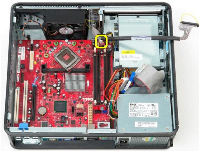
12. Déposez les vis qui fixent la carte système au châssis de l'ordinateur.
