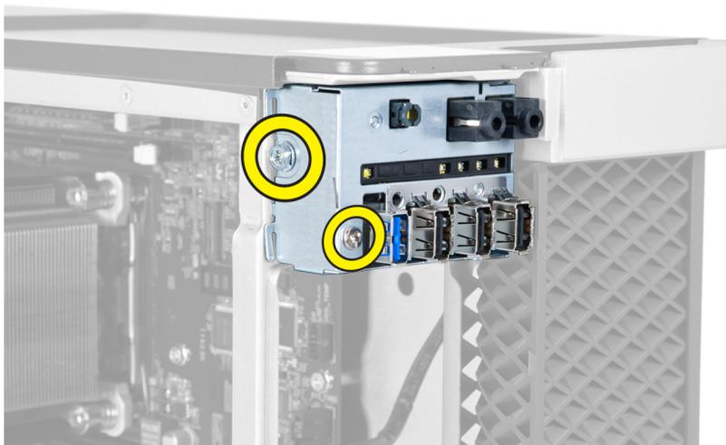
4. Retirez le module USB 3.0 du châssis.
