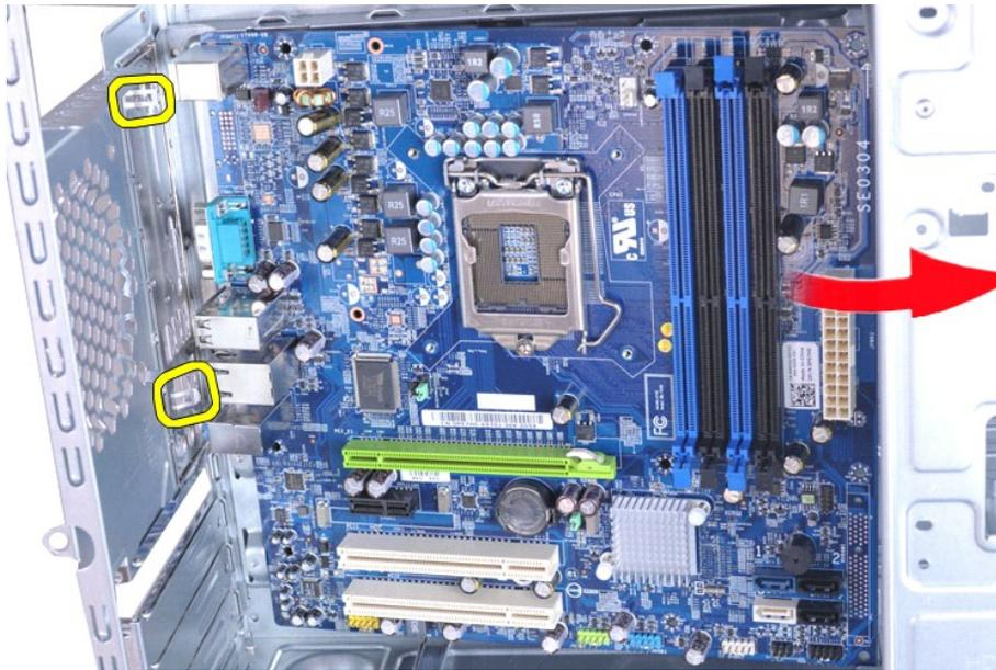
**⚠ 警告:** システム基板を取り付ける場合は、システム基板を金属製タブの下へスライドさせてください。システム基板を金属性タブの上に取り付けるときに強く押すと、システム基板が損傷するおそれがあります。
