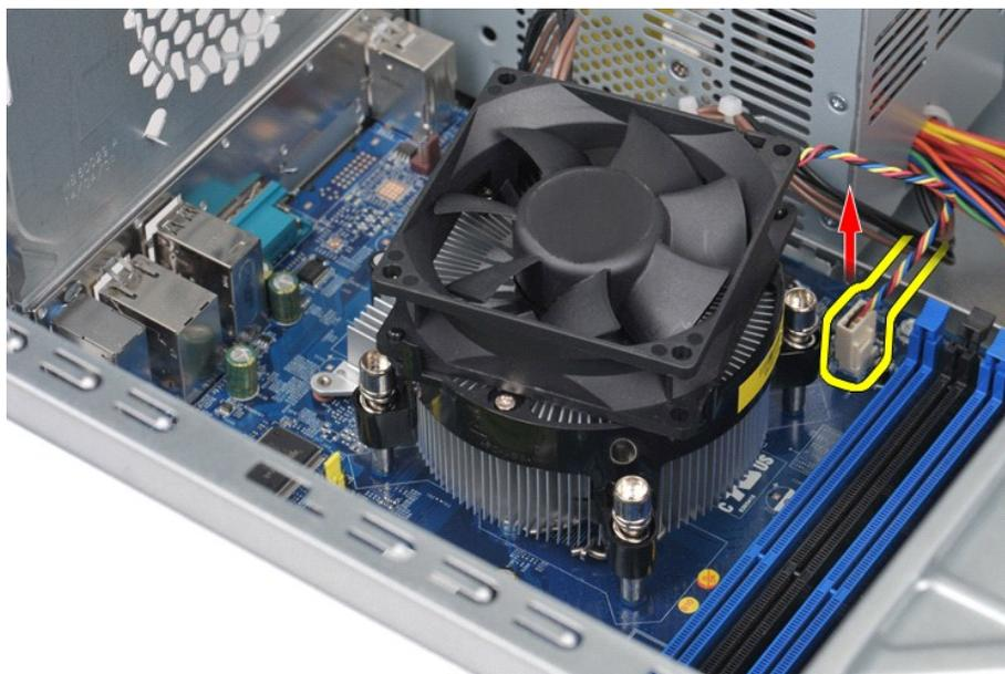
4. プラスドライバを使用して、ヒートシンクとファンアセンブリをシステム基板に固定している 4 本の拘束ネジを緩めます。
