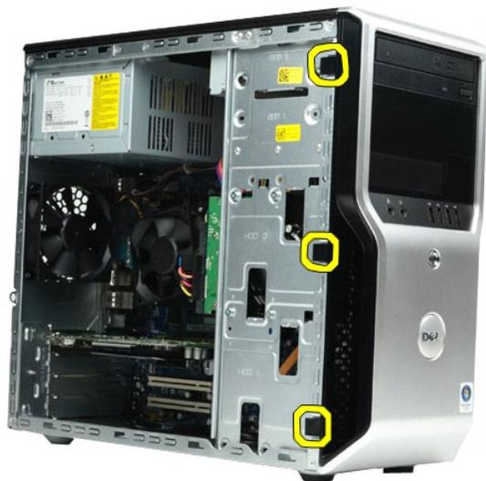
4. 前面パネルを回転させて、コンピュータから取り外します。
