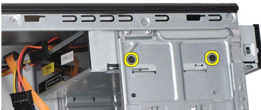
7. 光学ドライブを押してスライドさせ、コンピュータの前面から取り出します。
