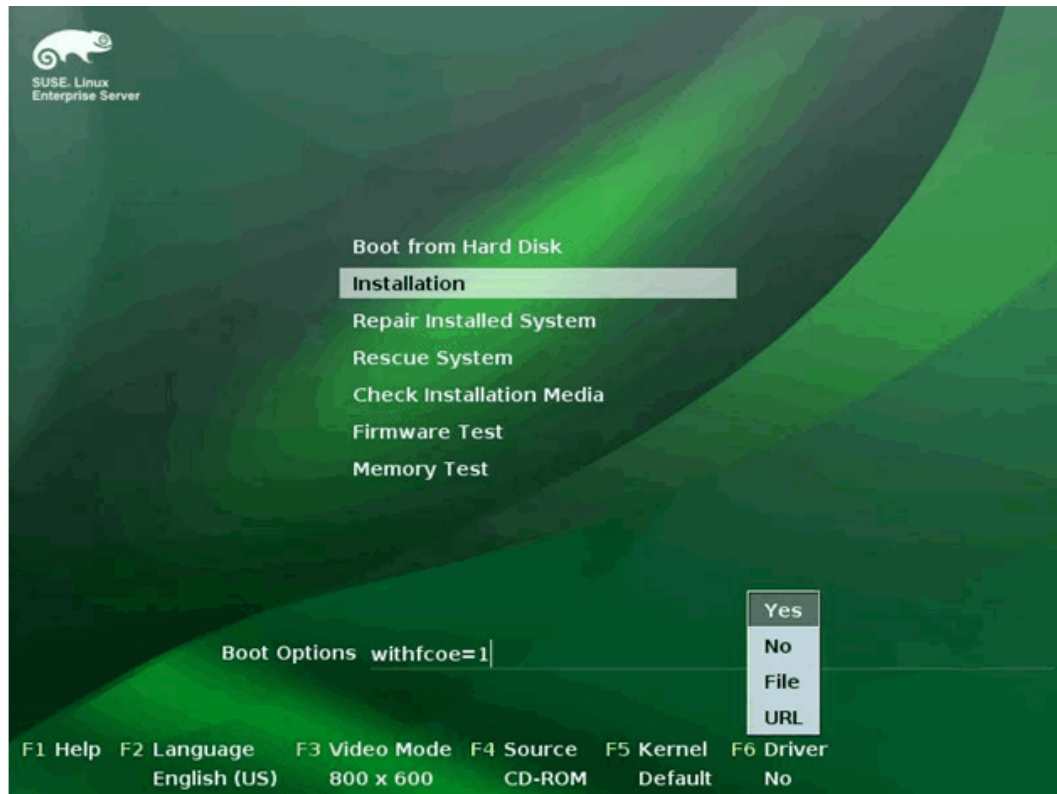
Ilustración 14-11. Inicio de la instalación SLES
