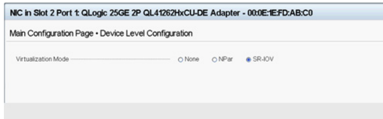
Ilustración 12-9. System Setup for SR-IOV: Integrated Devices (Configuración del sistema para SR-IOV: Dispositivos integrados)
