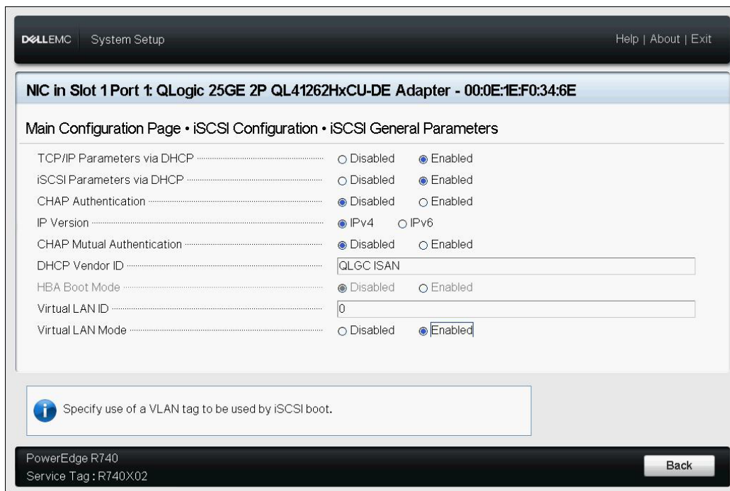
Ilustración 6-15. System Setup: iSCSI General Parameters, VLAN ID (Configuración del sistema: Parámetros generales iSCSI, Id. de VLAN)
