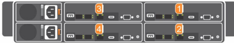
그림 4. 1U 노드를 위한 시스템 보드 4개의 열거
