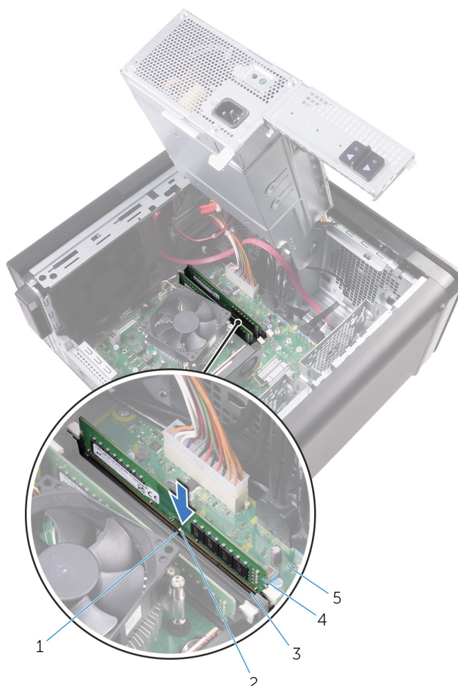
Figura 23. Remontarea modulului de memorie
