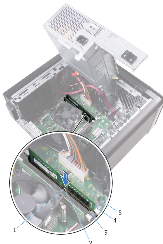
Figure 23. Remise en place du module de mémoire
