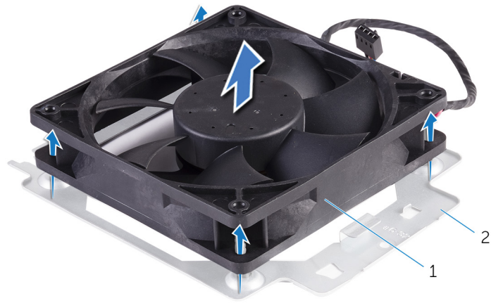
Figure 33. Retrait du ventilateur du châssis
