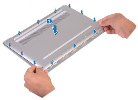
2 Recoloque os oito parafusos (Torx, M2x3) que prendem a tampa da base ao conjunto do apoio para as mãos.
