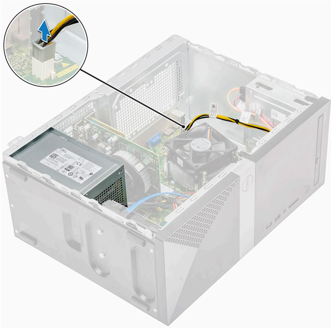
b Rimuovere i cavi della PSU dalle clip di contenimento.
