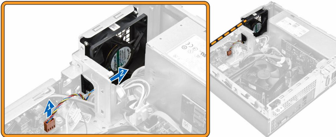
4. Retire os parafusos que fixam a ventoinha do sistema ao chassis do computador e memova-a co computador. [1,2]
