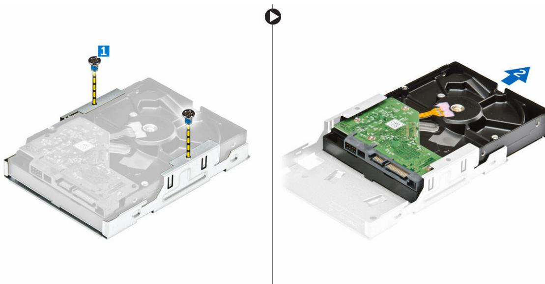
**NOTA:** Apenas retire o suporte da unidade de disco rígido se estiver a substituir a unidade. Se a remoção da unidade de disco rígido fôr apenas um pré-requisito para a remoção de outros componentes, ignore o passo 5.
