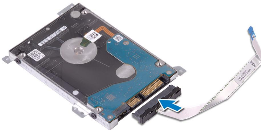
4. Alinee los orificios para tornillos del ensamble de disco duro con los orificios para tornillos del ensamblaje del teclado y el reposamanos [1].
