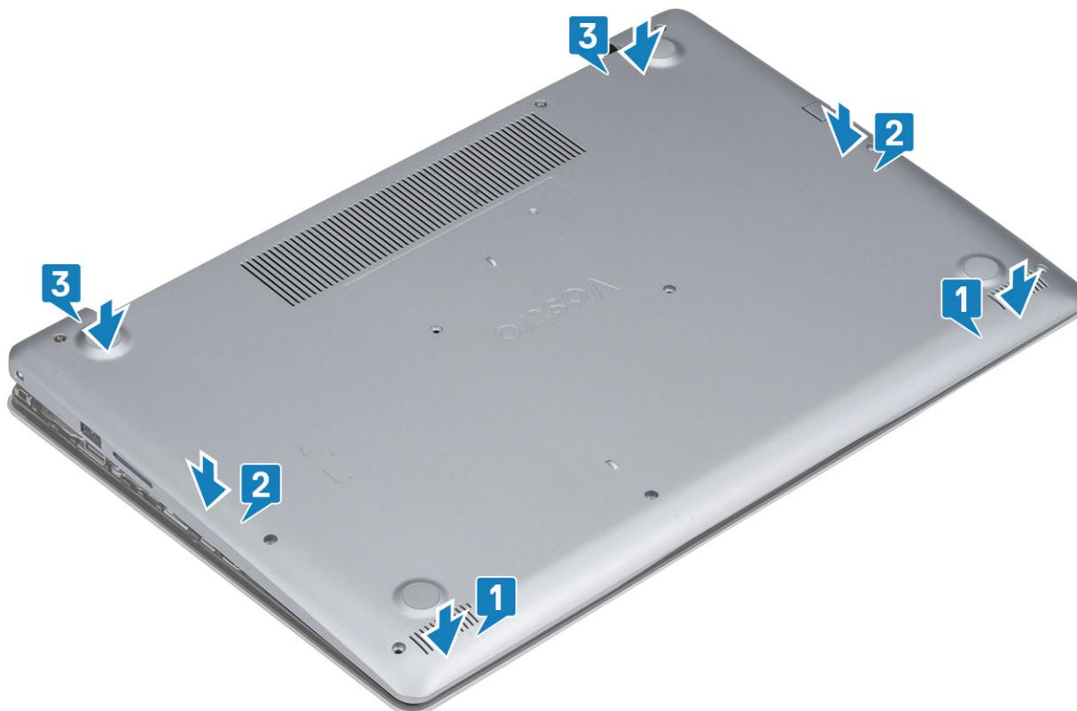
3. Ajuste los tres tornillos cautivos y reemplace el único tornillo (M2x4) que fija la cubierta de la base al ensamblaje del teclado y el reposamanos [1, 2].
