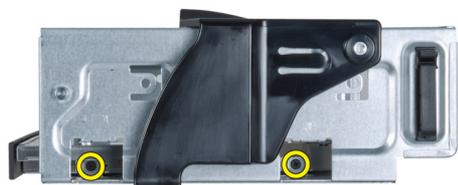
10 オプティカルドライブをオプティカルドライブケースに固定しているネジを外します。
