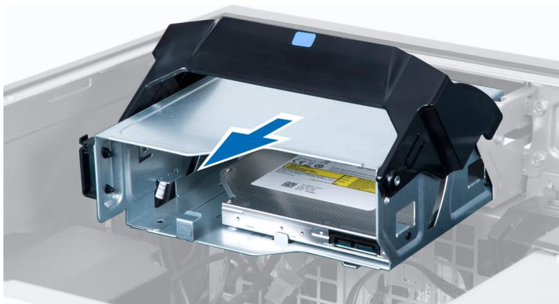
9 オプティカルドライブをオプティカルドライブケースに固定しているネジを外します。
