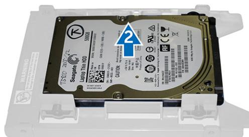
7 3.5 インチハードドライブが取り付けられている場合は、両側のハードドライブブラケットを曲げ、ハードドライブを緩めます。
