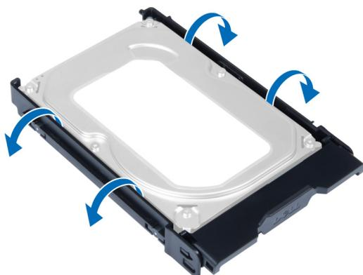
8 ハードドライブを上方向に持ち上げ、ハードドライブブラケットから取り外します。
