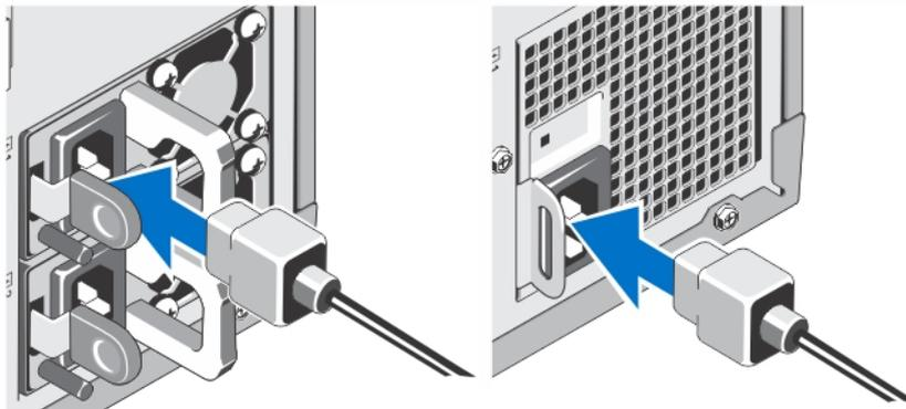
**Figure 3. Branchement du ou des câbles d'alimentation**
