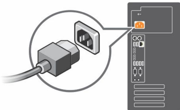
**Angka 2. Menghubungkan Kabel Daya**
