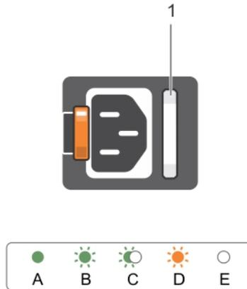
Abbildung 9. Statusanzeige des Wechselstrom-Netzteils
