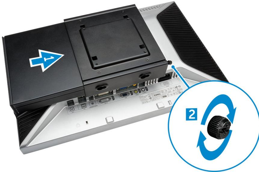
3. 電源アダプタケースをスライドさせて、デュアル VESA マウントの底にある溝に通してロックします。
