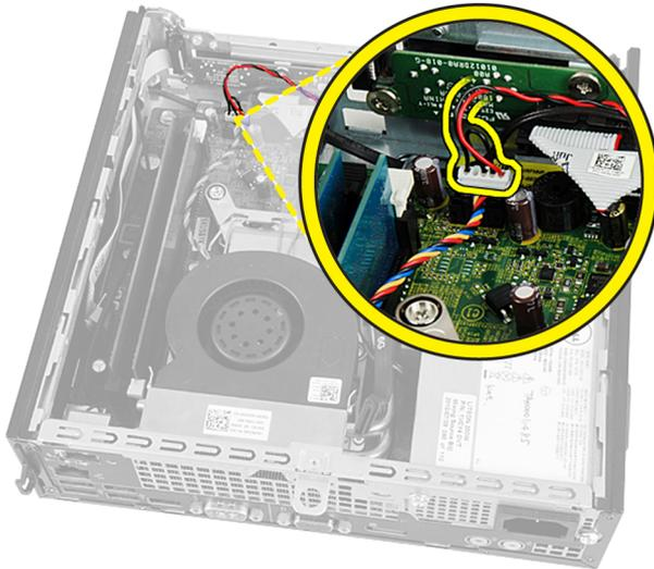
4. Lepaskan kabel speaker dari bawah kabel kipas sistem dan kabel antena WLAN (jika terpasang).
