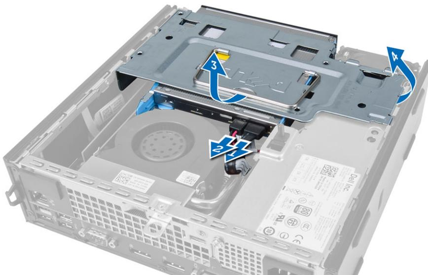
4. Lepaskan kabel data dan kabel daya dari bagian belakang hard drive dan keluarkan sangkar hard-drive dari komputer.
