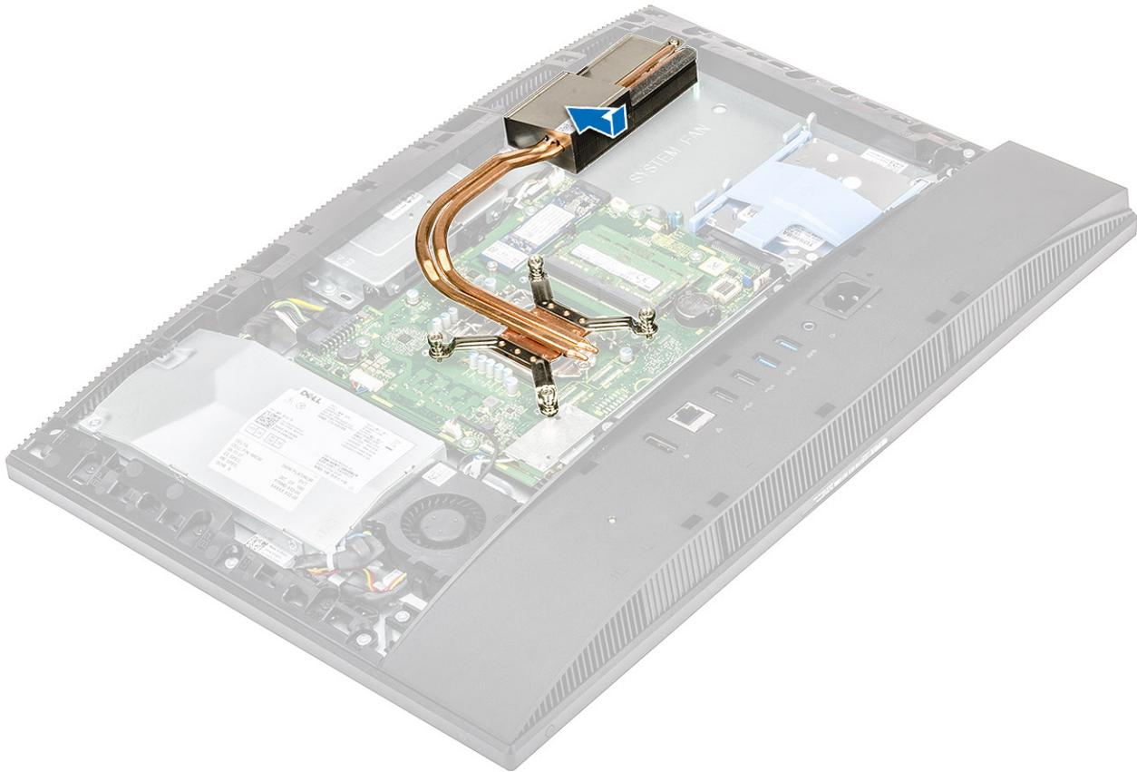
2. Aperte os cinco parafusos prisioneiros em ordem sequencial [1,2,3,4,5] para fixar o dissipador de calor à placa de sistema e à base do conjunto da tela..
