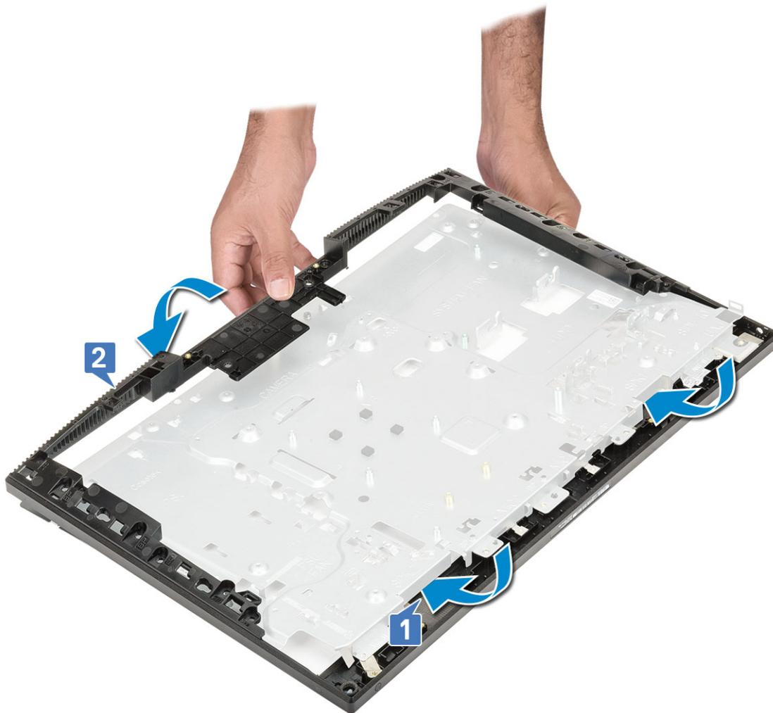
2. Drücken Sie die Laschen des mittleren Rahmens in die Aussparungen auf der Grundplatte der Bildschirmbaugruppe und befestigen Sie sie dort [1].
