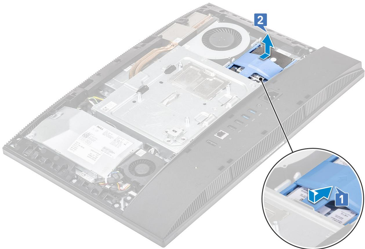
4. So entfernen Sie die Laufwerkshalterung:
