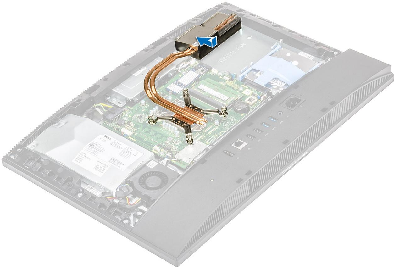
2. Ziehen Sie die fünf unverlierbaren Schrauben nacheinander [1,2,3,4,5 ] fest, um den Kühlkörper an der Systemplatine und der Grundplatte der Bildschirmbaugruppe zu befestigen..
