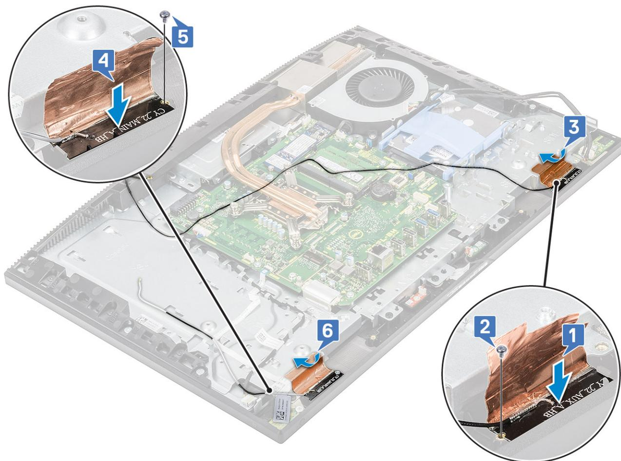
d) Führen Sie die Antennenkabel durch die Kabelführungen auf der Grundplatte der Bildschirmbaugruppe [1,2].
