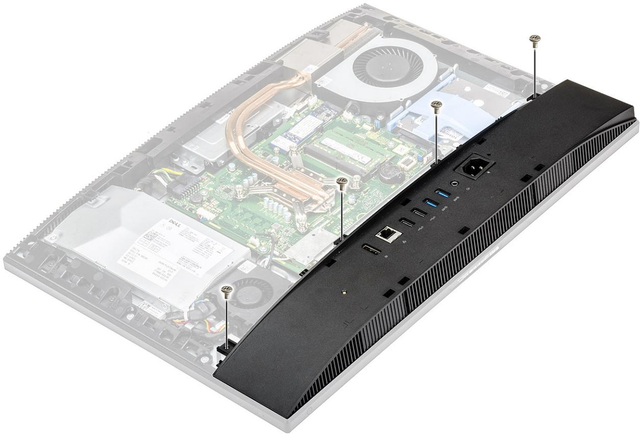
4. Hebeln Sie die Bodenabdeckung vom mittleren Rahmen ab und heben Sie sie an.
