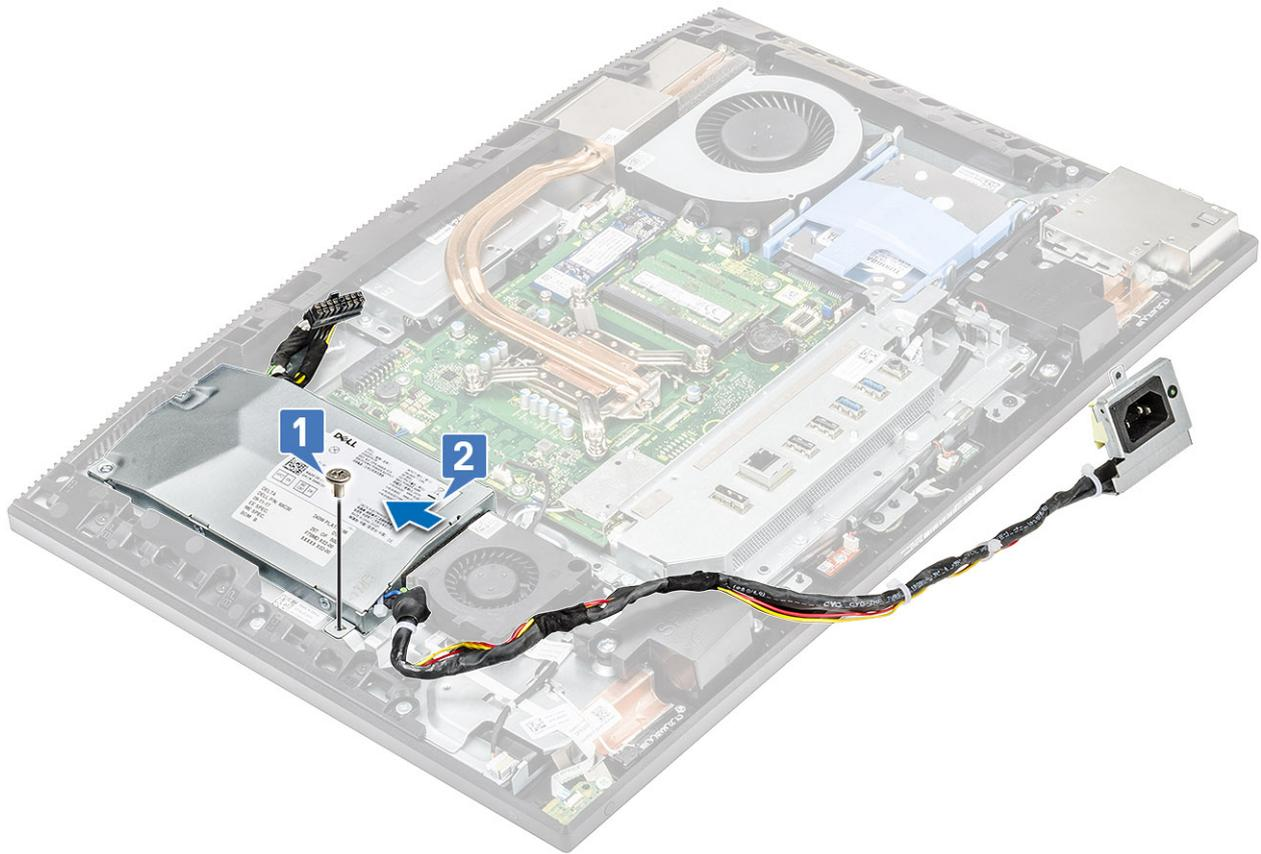
b) Schieben Sie das Netzteil heraus und heben Sie es aus dem Gehäuse .
