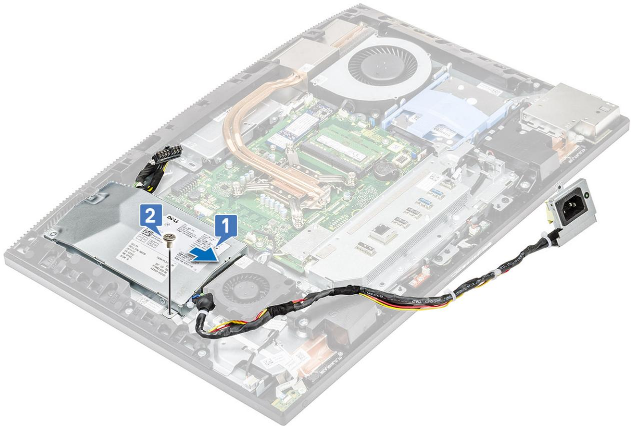
2. So installieren Sie das Netzteilkabel:
