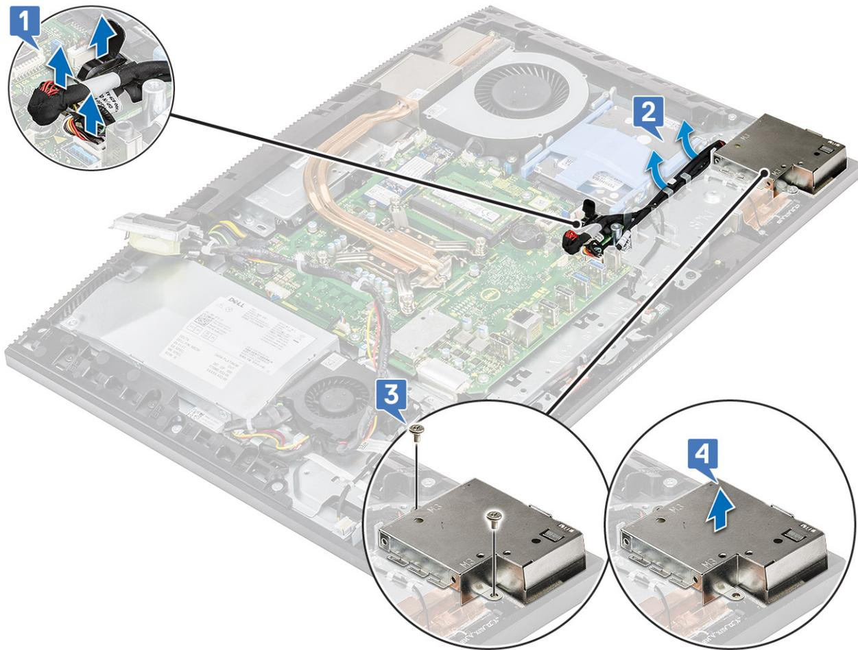
4. So entfernen Sie die E/A-Platine:
