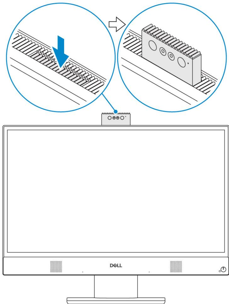
i | **NOTIFICARE:** Extindeți camera în timp ce utilizați orice funcție a camerei, astfel încât camera să nu fie blocată.
