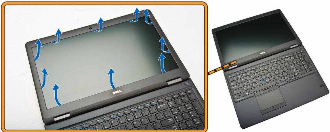
3. Extraiga el embellecedor de la pantalla del ensamblaje de la pantalla.
