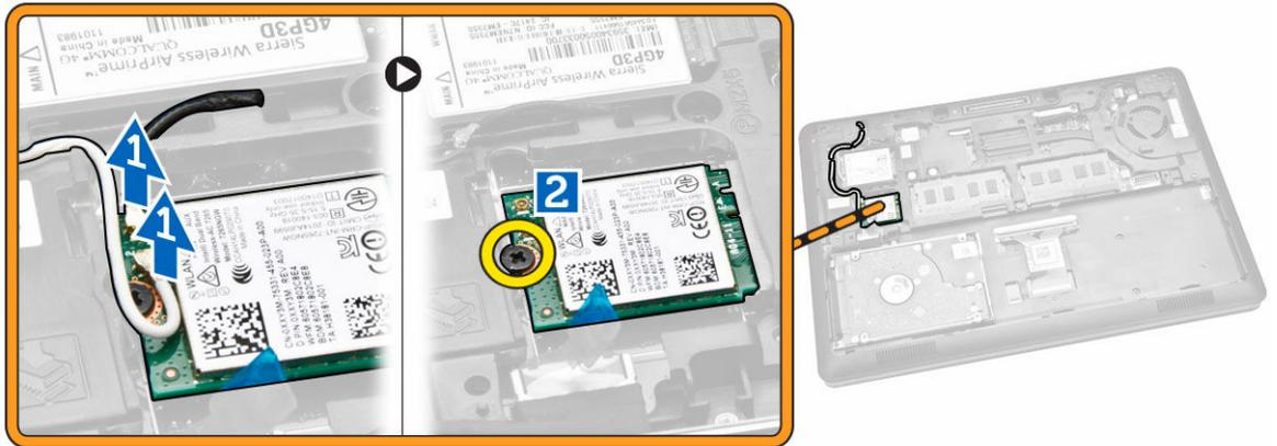
4. Extraiga de la tarjeta WLAN del equipo.
