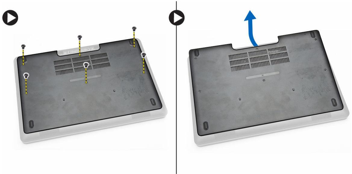
**NOTA:** Puede que necesite una herramienta puntiaguda para levantar la cubierta de la base desde su borde.
