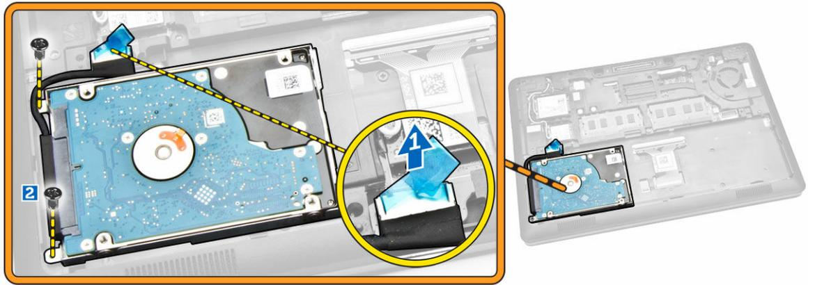
4. Extraiga el ensamblaje de la unidad de disco duro del equipo.
