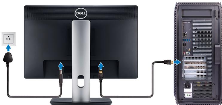
**メモ:** お使いのコンピュータに搭載されているディスクリートグラフィックスカードに、ディスプレイを接続してください。
