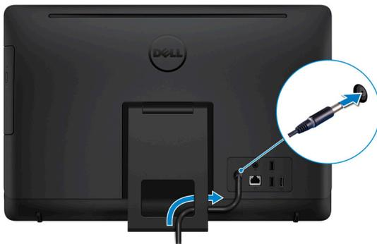
**Figura 5. Collegamento dell'adattatore di alimentazione al piedistallo a cavalletto**
