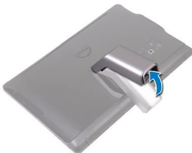
**Figura 1. Sollevamento del supporto di montaggio.**
