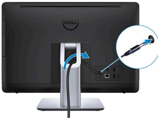
**Figura 6. Collegamento dell'adattatore di alimentazione con il piedistallo a colonna**
