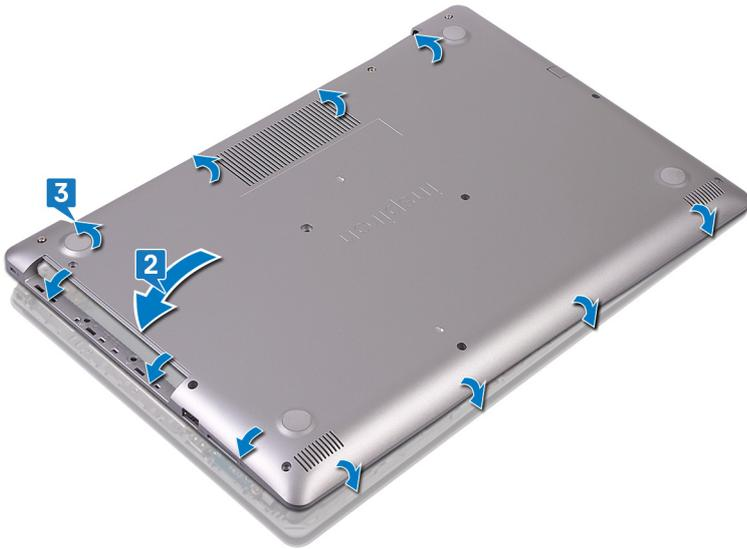
4. Bringen Sie die sechs Schrauben (M2,5x7) wieder an, mit denen die Bodenabdeckung an der Handballenstützen- und Tastaturbaugruppe befestigt wird.
