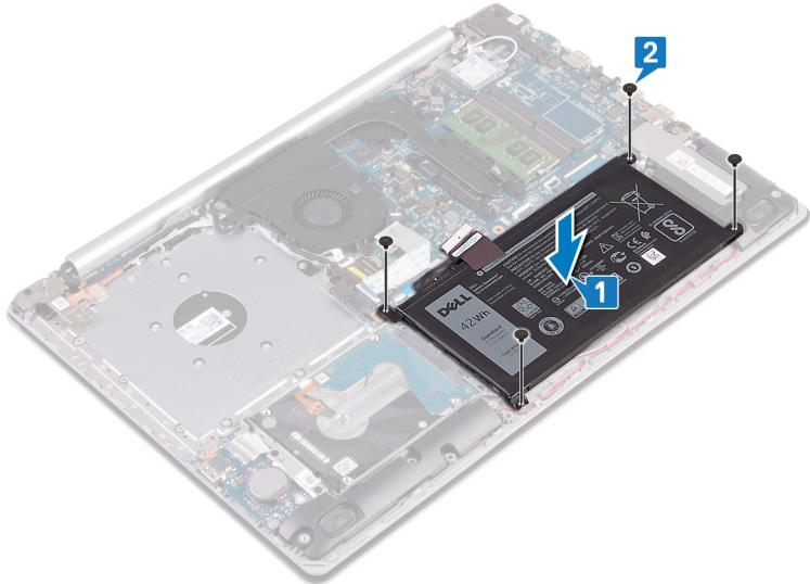
3 バッテリーケーブルをシステム基板に接続します。
